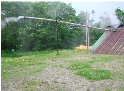
■③排煙を冷却して木酢液を採取する ※ステンレス製円筒、ポリエチレン製の回収貯留タンク
