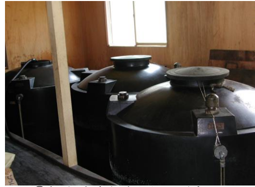
■⑤粗木酢液を貯留タンク(室内)にて静置する 約3ヶ月以上 ナラ木炭、活性炭使用
