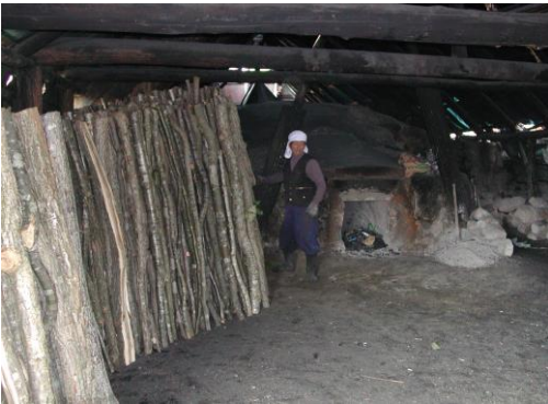
■②炭材を立て積みにして土窯で炭化する
